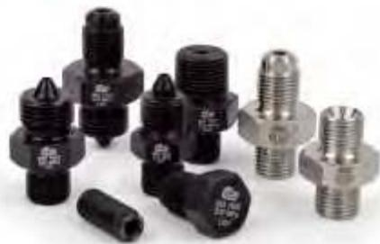
どんな状況下でも安全でトラブルの無い接続は大変重要です。セインの種類豊富なアダプターは、ほとんどのカップリングとホースに合う幅広い接続を用意しています。アダプターは全て、スチール製（黒色亜鉛鍍金）で、使用圧力は、100MPaから400MPaまでです。各アダプターの詳細につきましては、製品一覧をご覧ください。セインのラバー・メタルシールは、高圧アダプターとの使用に適しています。品番やその他の情報につきましては、セインのシール製品をご参照下さい。
